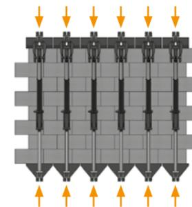
Der Greifer besteht aus 6 einzelnen Greifarmen (an jeder Stelle optimaler Druck), die durch Federstahl miteinander verbunden sind. Dadurch passt sich der Greifer der Steinlage auch bei extremen Toleranzen an.
