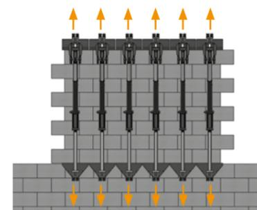
Beim Lösen der Greifarme gehen die Steine auf Abstand: lockere Verlegung.
